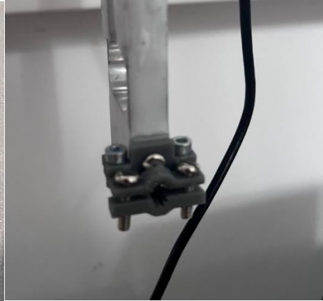
Figure 21 Assemblage des composants mécaniques sur le capteur de force
